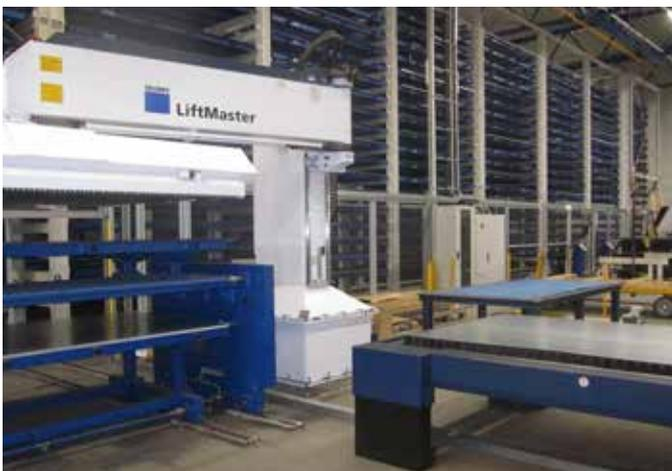
Handling-Einrichtung der Laserschneidanlage kommuniziert direkt mit Automatiklage
