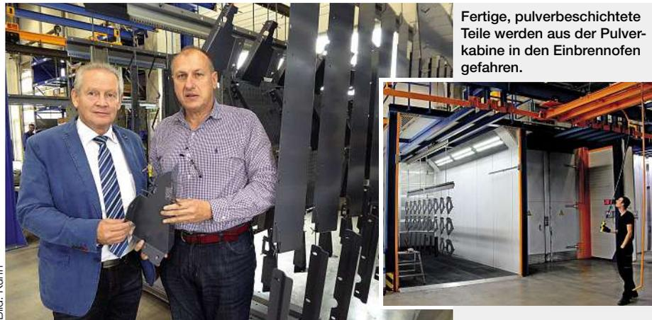
Fertige, pulverbeschichtete Teile werden aus der Pulverkabine in den Einbrennofen gefahren.
